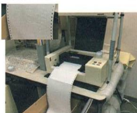
点字プリンタでの点字印刷。1行ずつ印刷されるので1ページあたり120秒程度の時間がかかります。
